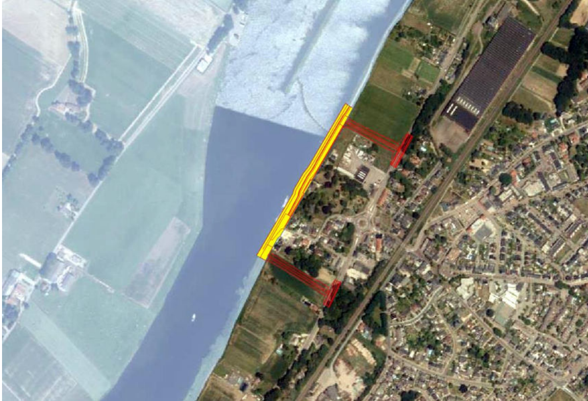
Afbeelding 3.5 Ligging dijkversterking Belfeld (rood) ten opzichte van het KRW-waterlichaam (blauwe arcering). Met in geel het permanente ruimtebeslag van 0,90 ha in het KRW-oppervlaktewaterlichaam.
