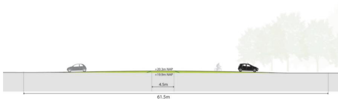
Figuur 3-5 Ophoging van de dijk bij de aansluiting op de Rijksweg
