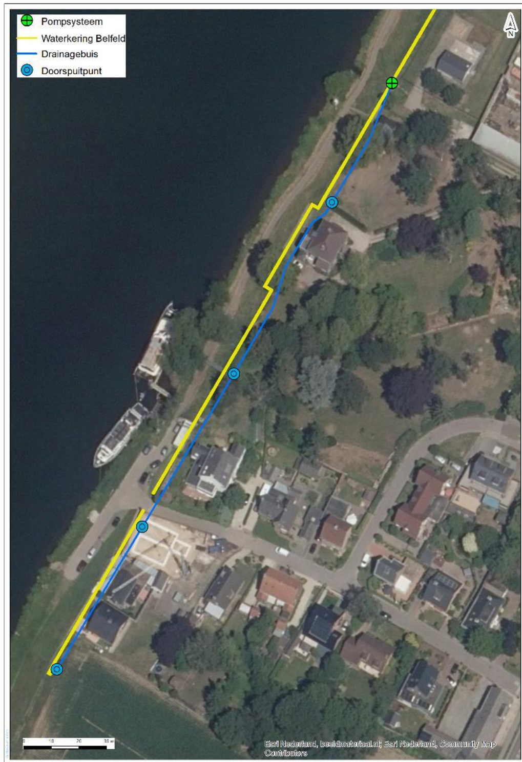
Figuur 11 Ligging drainagesysteem
