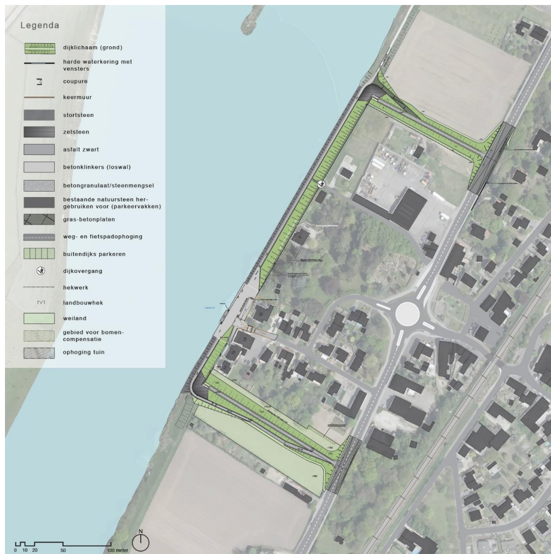
Figuur 3-14 Uitsnede zuidelijk deel ingepast VKA inclusief fietsverbinding als meekoppelkans aan de zuidzijde van de dijk, aansluitend op de loswal
