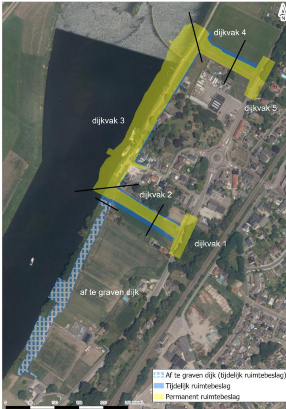
Figuur 1-2 Locatie werkzaamheden met dijkvakindeling voor de dijkverbetering bij Belfeld
