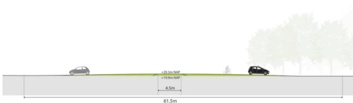
Figuur 1-5 Ophoging van de dijk bij de aansluiting op de Rijksweg
