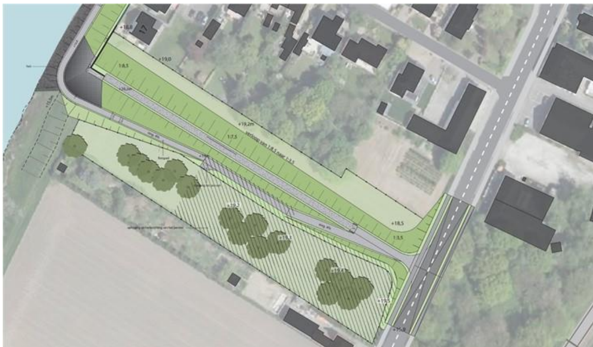
Figuur 1-14 Uitsnede zuidelijk deel referentie-ontwerp inclusief fietsverbinding als meekoppels aan de zuidzijde van de dijk, aansluitend op de loswal.
