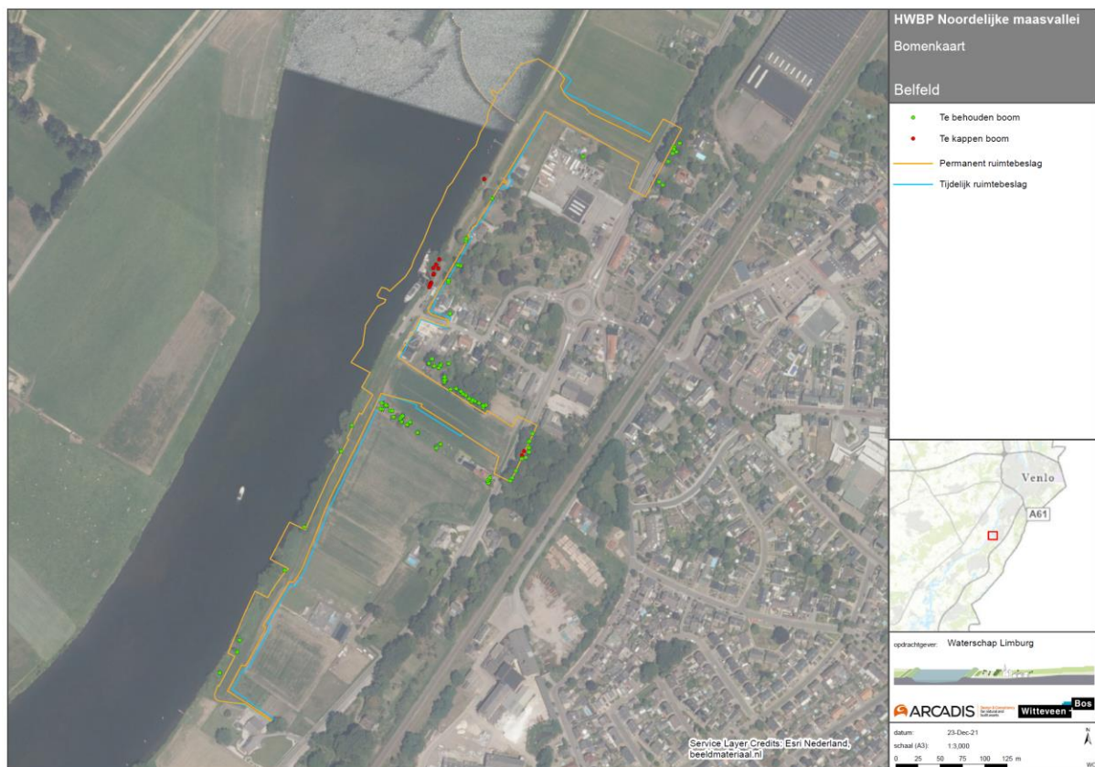
Figuur 4-1 - Tijdelijk en permanent ruimtebeslag dijkverbetering Belfeld
