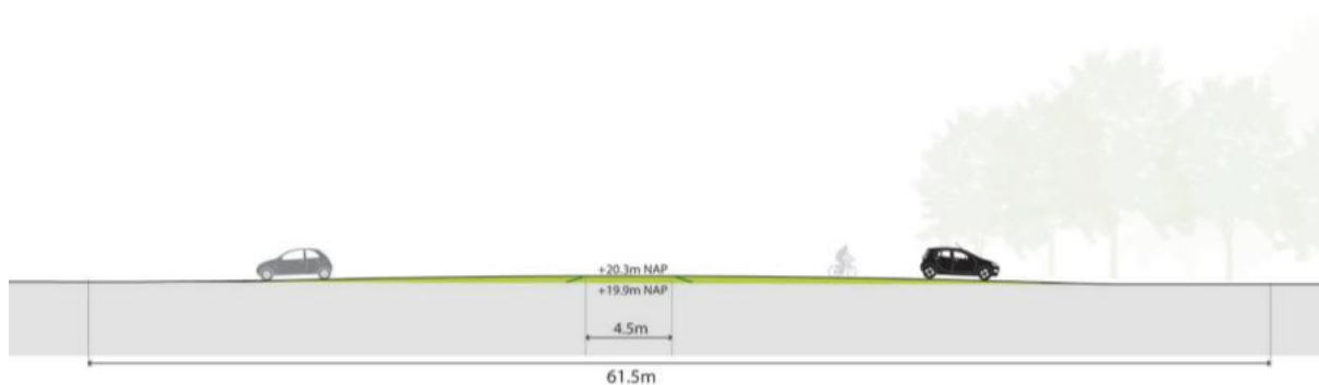
Figuur 3-2 Ophoging van de dijk bij de aansluiting op de Rijksweg
