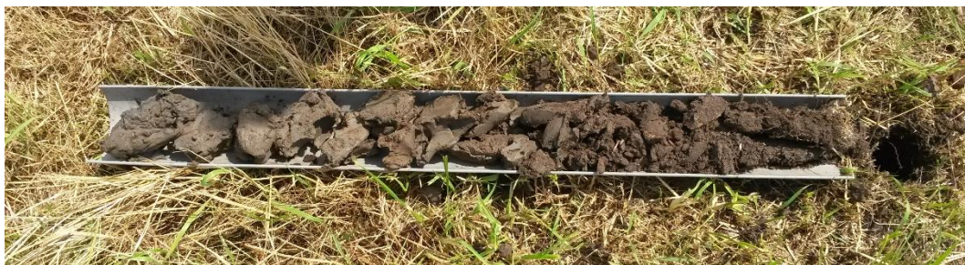
Figuur 23 Bodemprofiel van locatie 1 tot 1 meter diepte. Bovenzijde profiel aan rechterzijde foto.
