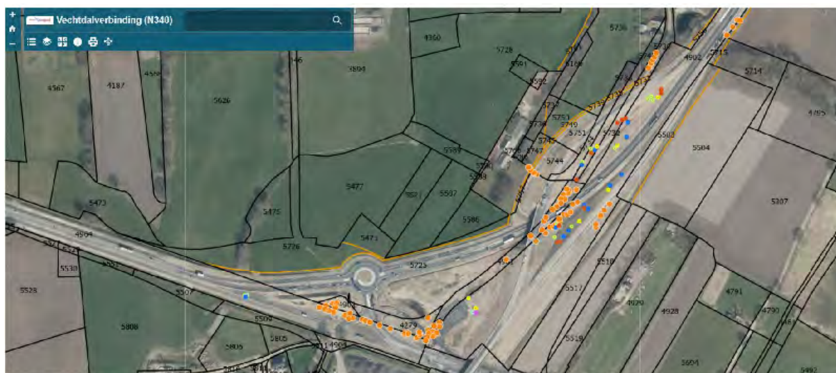
Figuur 12: Gekapte losse bomen (oranje) bij knooppunt Varsen en herplant (diverse kleuren). Vanwege de aanwezigheid van kabels en leidingen in de ondergrond en gebruik van immobilisaat als ophoogmateriaal zijn de herplantmogelijkheden beperkt.
