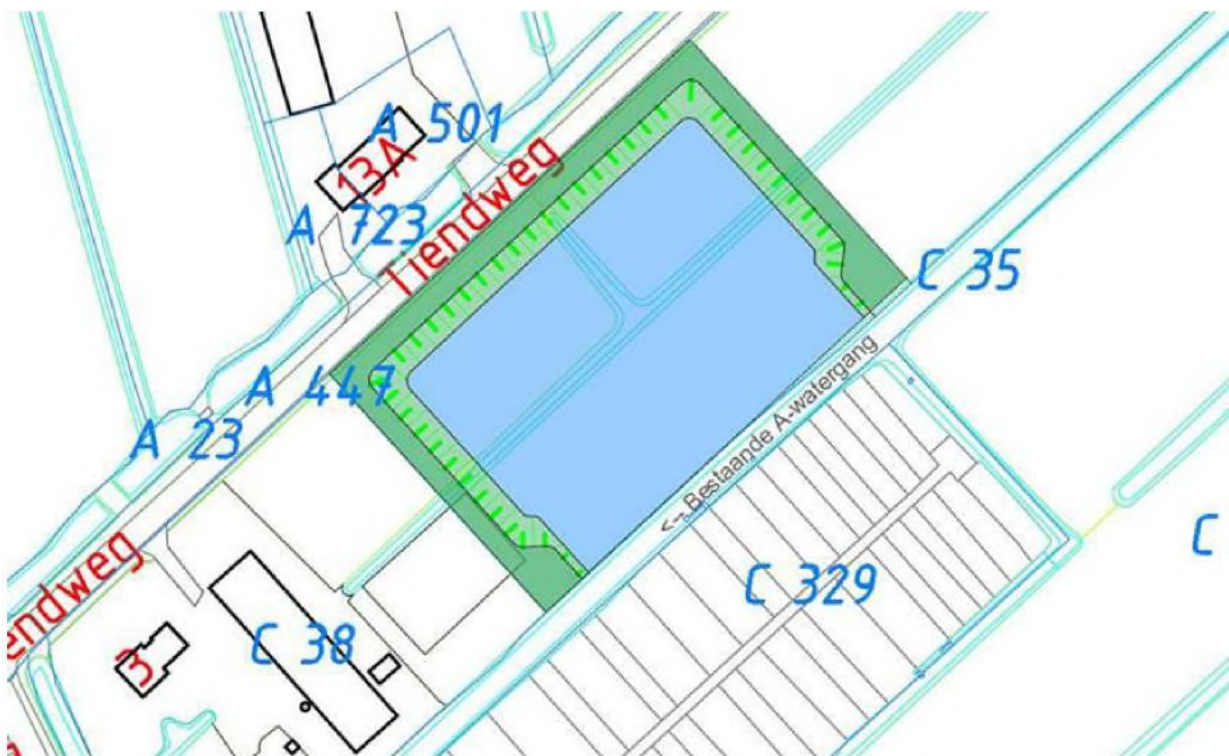
Figuur 2 Schetsontwerp van de waterbergingslocatie Ameide West. (Blauw: natte waterberging, lichtgroen: NVO en donkergroen: onderhoudspad met draaiplaatsen)
