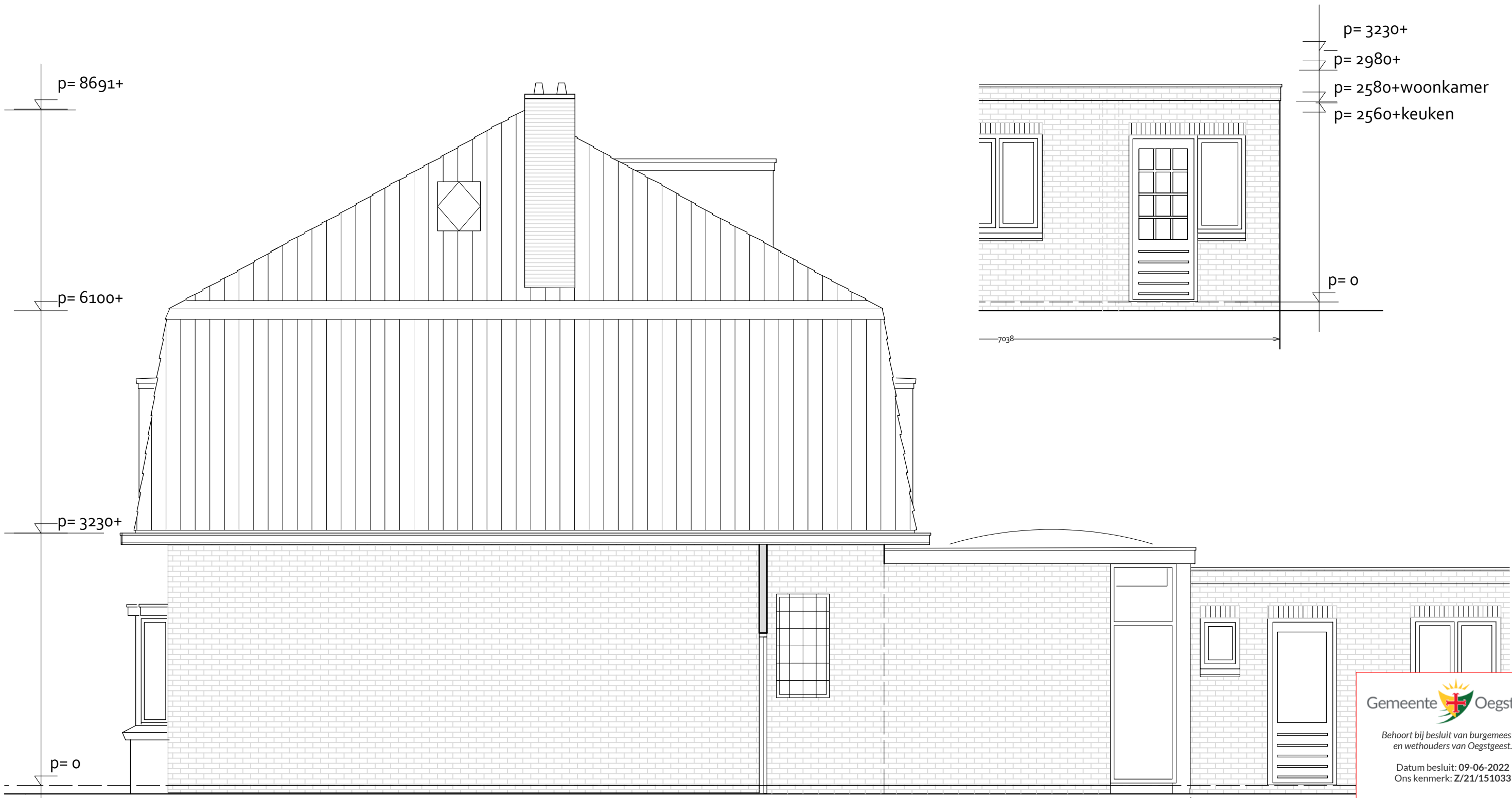
Zijgevel bestaande toestand
