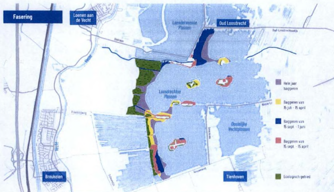
Afbeelding 2. Fasering baggerwerkzaamheden Loosdrechtse Plassen
