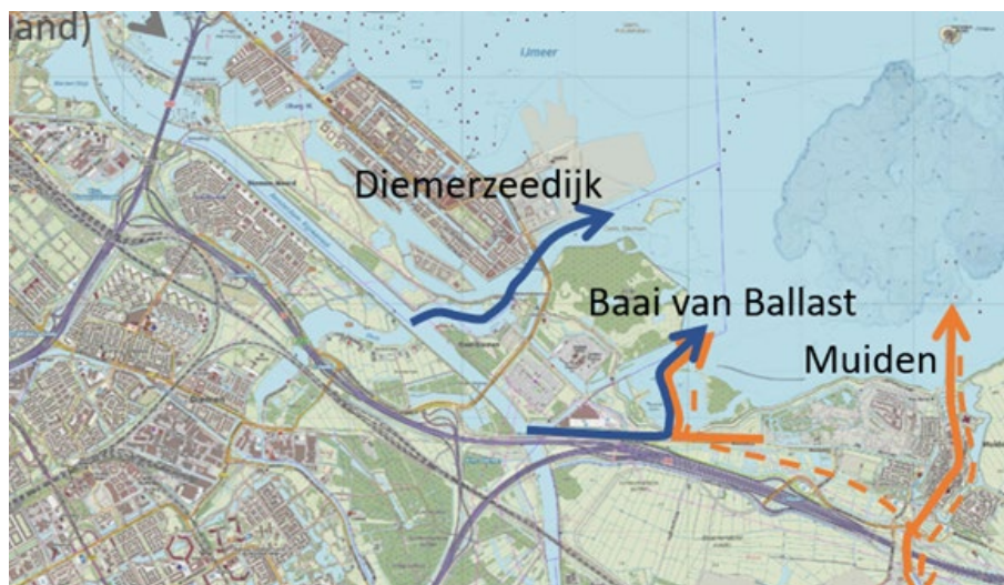
Figuur 2.4 Overzicht van drie mogelijke locaties voor een extra gemaal tussen het Amsterdam-Rijnkanaal en het Markermeer, met in kleur de waterstromen uit het Amsterdam-Rijnkanaal zelf (blauw) en de Vecht (oranje)
