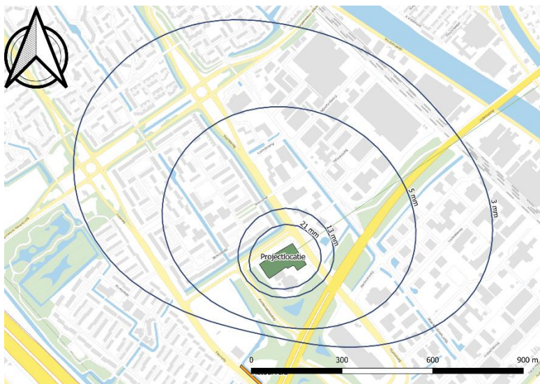
Figuur 8 Berekende zettingen als gevolg van de bemaling
