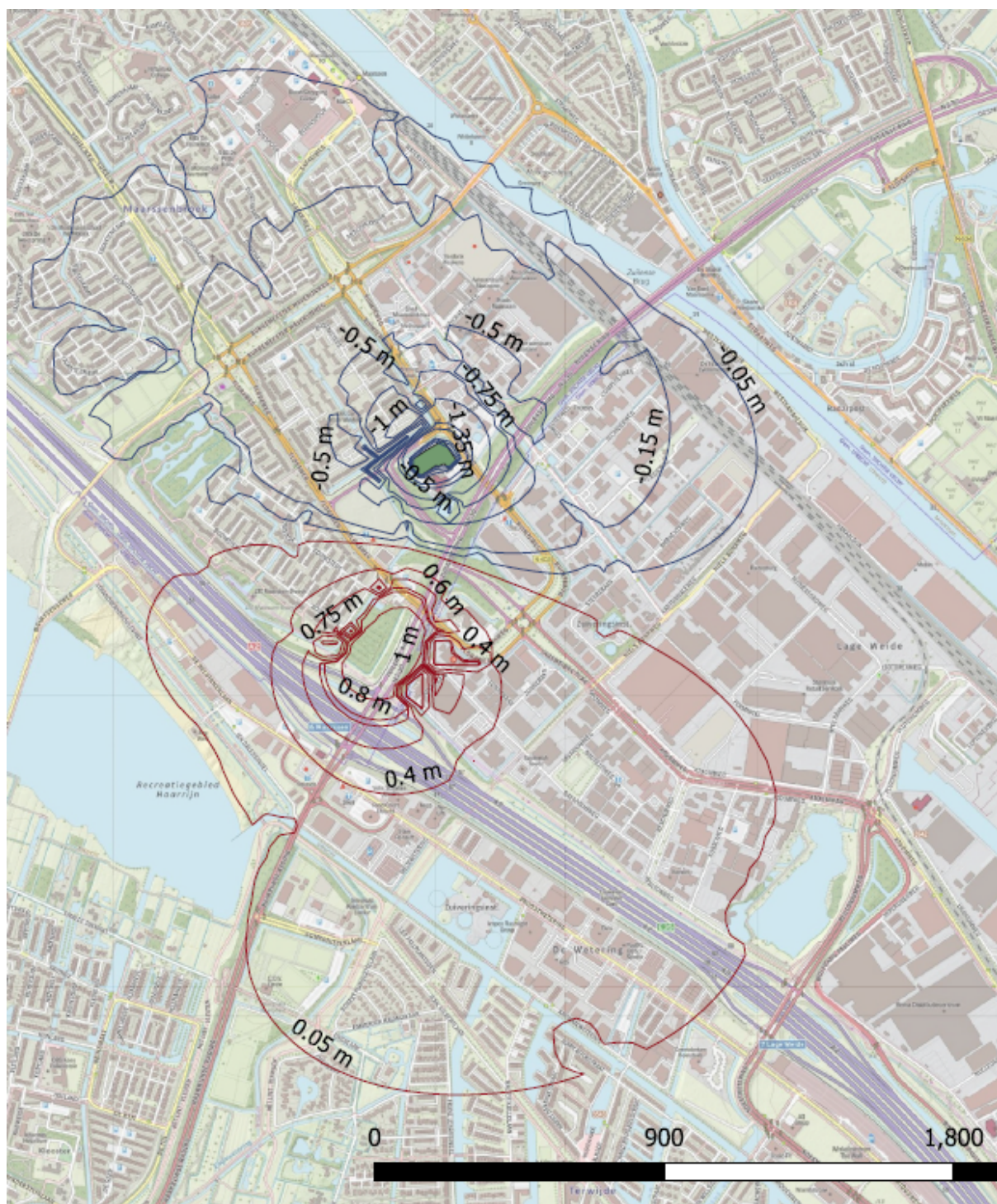
Figuur 3a: Freatische grondwaterstand (in deklaag) bij aanleg poeren en liftputten bij GLG
