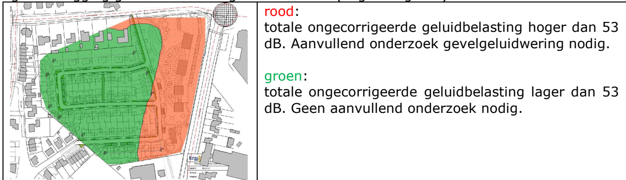
figuur 4: ligging geluidcontour wegverkeer totaal (ongecorrigeerd)
