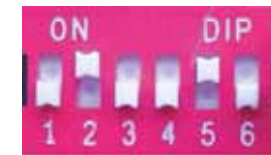
Blokje met 6 dipswitches
