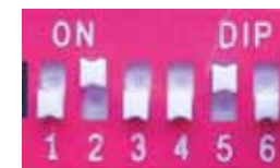
Bloque con 6 conmutadores DIP
