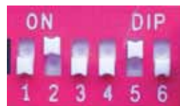
Bloc comprenant les 6 commutateurs DIP
