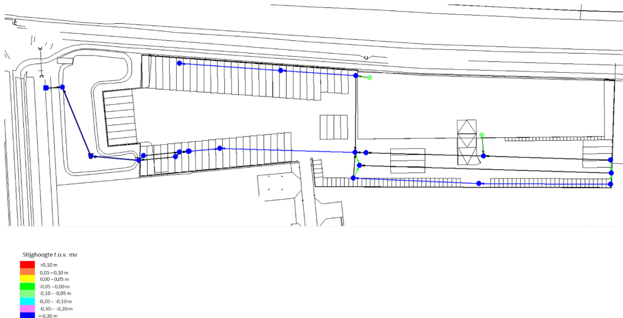
Figuur 5-2 weergave van het hydraulisch functioneren van het stelsel bij ontwerp bui 08 (weergave stijghoogte in meters t.o.v. maaiveld)
