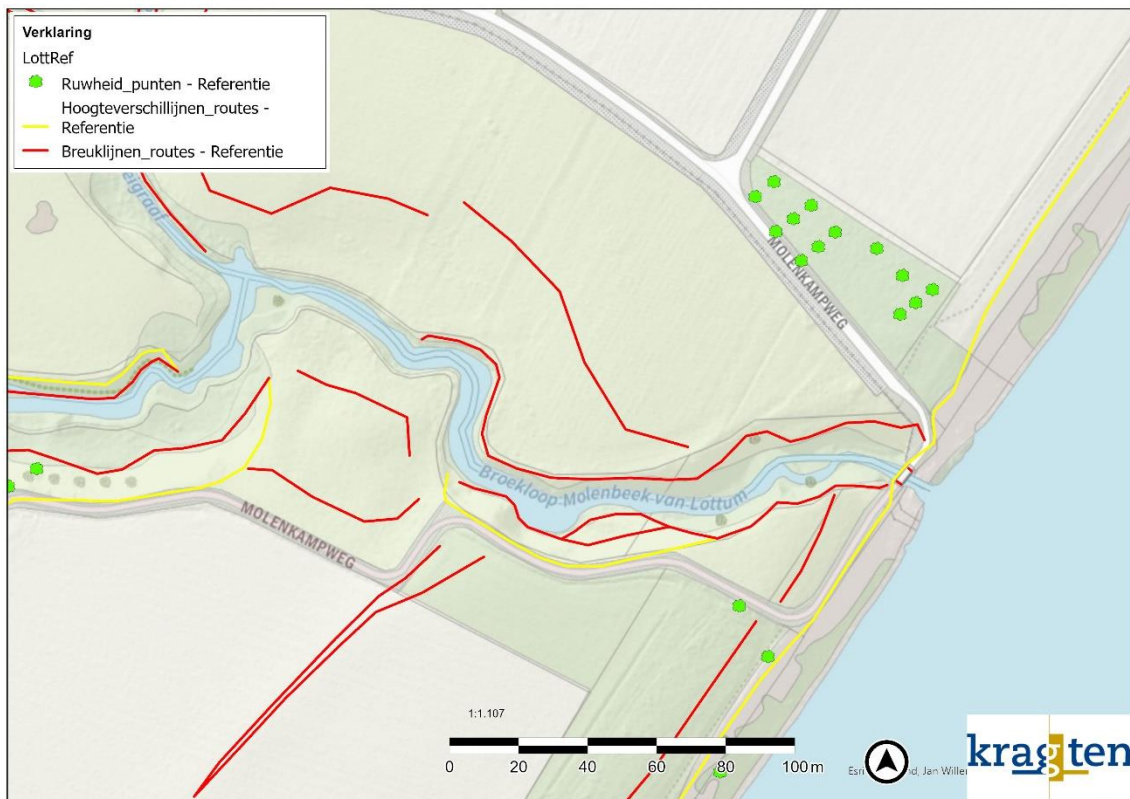
Afbeelding 3. Breuklijnen, hoogteverschillen en ruwheidspunten (o.a. bomen) bij de monding in LottRef.
