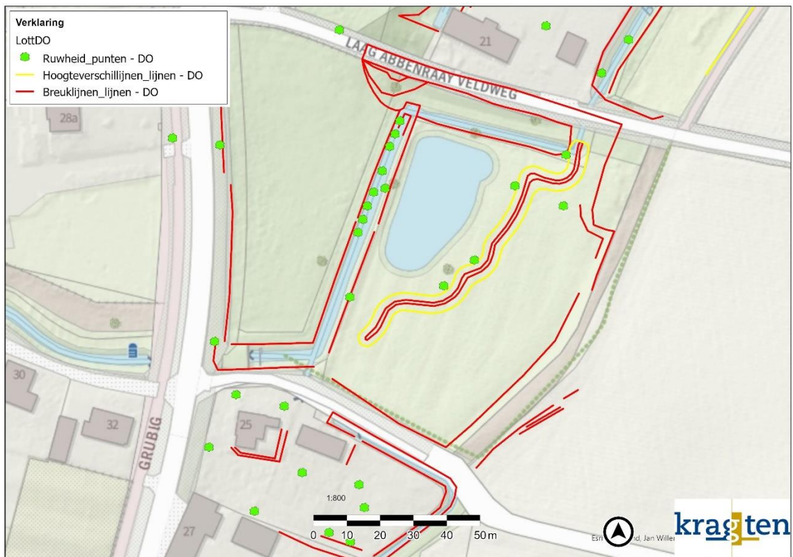
Afbeelding 6. Breuklijnen, hoogteverschillen en ruwheidspunten (o.a. bomen) bovenstrooms van de Molenbeek in LottDO.
