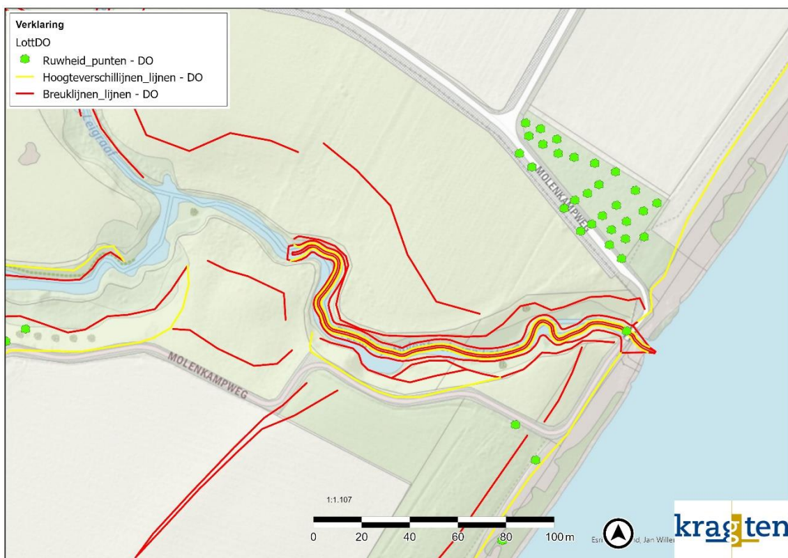
Afbeelding 5. Breuklijnen, hoogteverschillen en ruwheidspunten (o.a. bomen) bij de monding in LottDO.
