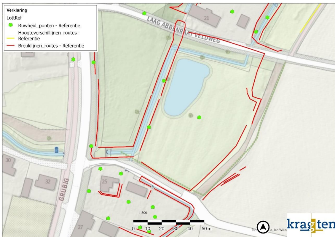
Afbeelding 4. Breuklijnen, hoogteverschillen en ruwheidspunten (o.a. bomen) bovenstrooms van de Molenbeek in LottRef.
