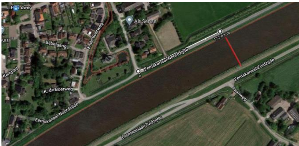
Figuur 1: In het rood globaal de locatie waar de zinker wordt verwijderd. In het wit globaal het tracé waaruit de leiding uit de waterkering ten noorden van het kanaal wordt verwijderd.
