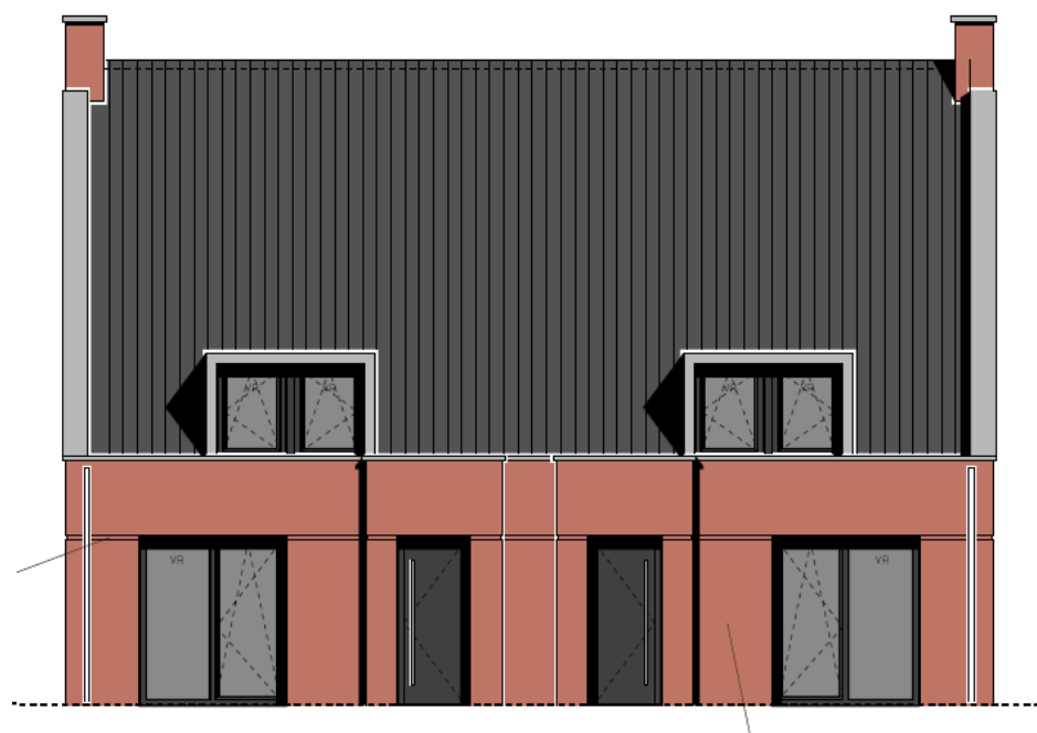
Afbeelding 4 | Toekomstige voorgevel twee-onder-een-kapwoning (bron: Sjaak Goud Architect)
