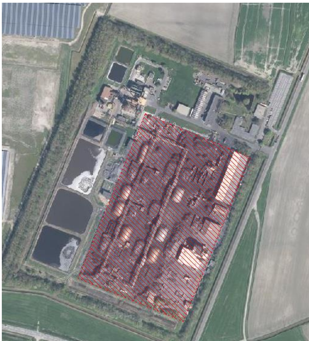
Figuur 4.1 Weergave invoer oppervlaktebron (rood gearceerd) in rekenmodel GeoMilieu
