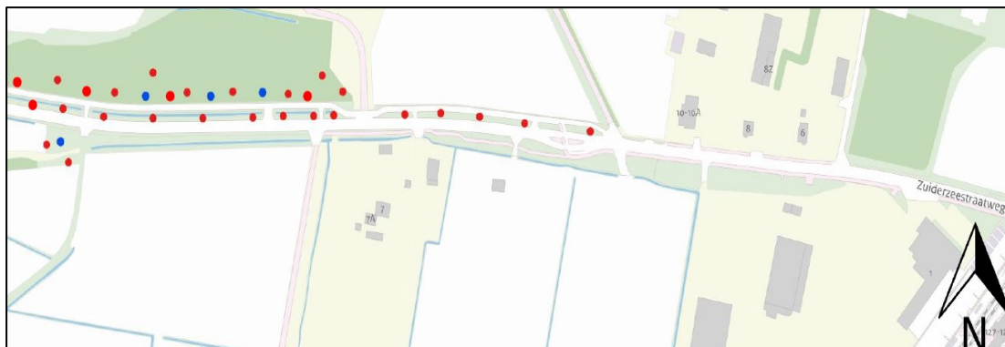
Figuur 4. De locaties van de permanente voorzieningen voor ruige dwergvleermuis en rosse vleermuis. De rode stippen weergeven de locaties van de 16 bolle kasten van het type VK WS 04 van Vivara Pro (of soortgelijk) voor de vier te mitigeren verblijfplaatsen van ruige dwergvleermuis en 12 kasten van hetzelfde type ter compensatie van één zomer/paarverblijfplaats van rosse vleermuis. Ook worden er voor rosse vleermuis 4 grote bolle kasten van het type Schwegler 1FW opgehangen (blauwe stippen). Alle kasten dienen opgehangen te worden aan bomen die behouden blijven en genoeg beschermt zijn.
