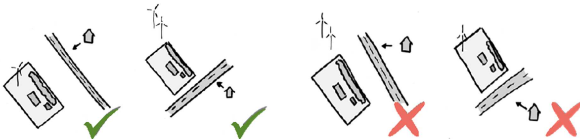
Afb. 9: de turbine(s) staat/staan op een ongeschikte positie ten opzichte van het voorerf, ontsluitingswegen en omwonenden (verbeeld door een huisje in de schema's). De exacte positionering vraagt maatwerk. (De schema's zijn niet persé noord-zuid georiënteerd.)
