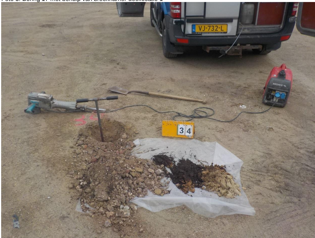
Foto 4: Boring 34 met behulp van breekhamer deellocatie 1
