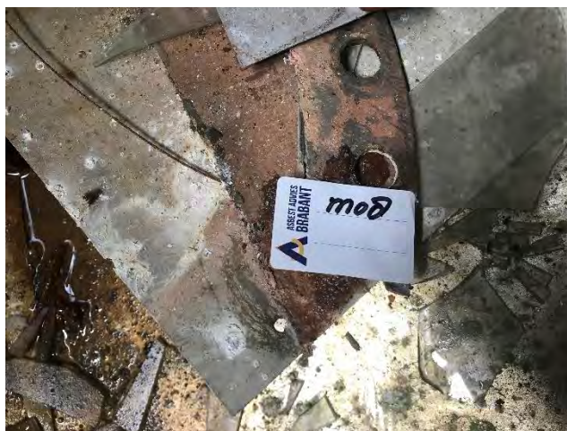
Foto 32 | Foto voor bron Pakkingen(los) op vloer
