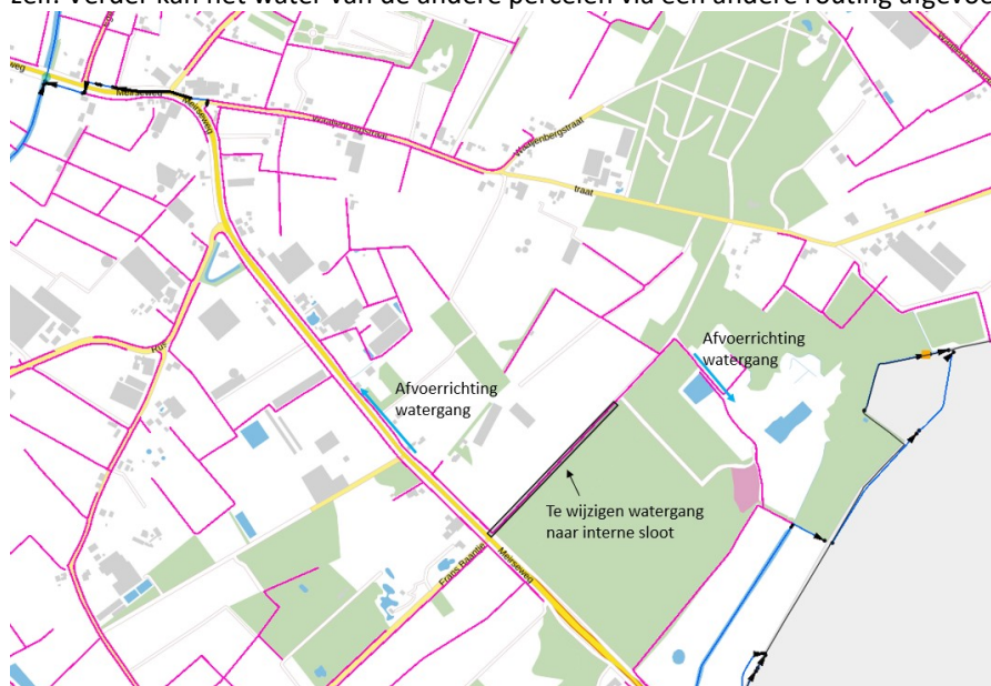
Figuur 7: Afvoerrichting watergangen
