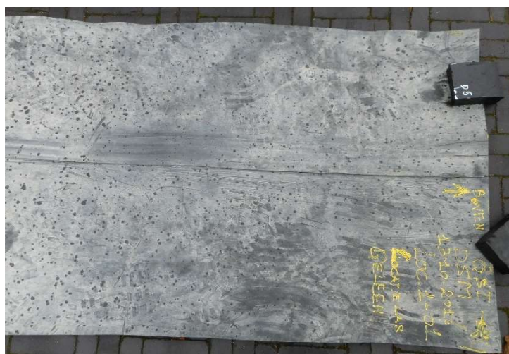
Fig. 2.1 Gedeelte van uitgesneden kanaallas van monster QST-161562 (Loc.1-01).
