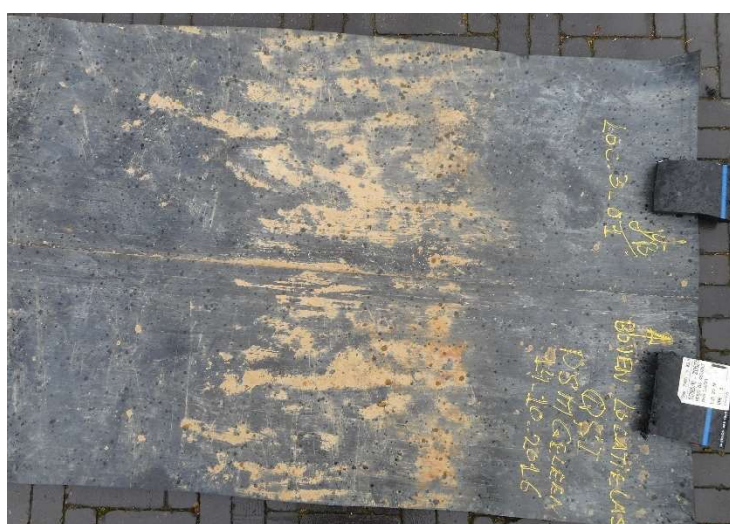
Fig. 2.5 Gedeelte van uitgesneden kanaallas van monster QST-161566 (Loc.3-01)
