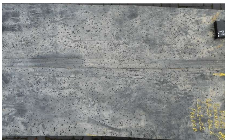
Fig. 2.2 Gedeelte van uitgesneden kanaallas van monster QST-161563 (Loc.1-02).
