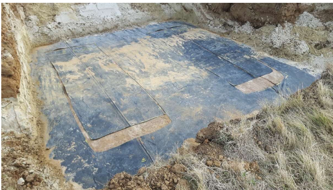
Fig. 4.6 Voorbeeld van krimp van uitgesneden delen ten opzichte van het gesneden gat; locatie 3.
