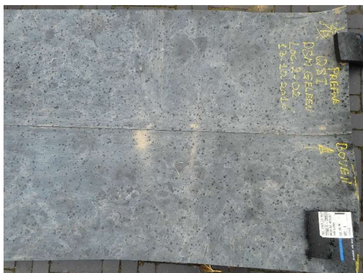
Fig. 2.4 Gedeelte van uitgesneden kanaallas van monster QST-161565 (Loc.2-02).
