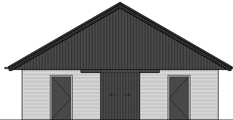
Achtergevel (N-0) Gevel prefab elementen steenstrip Opgevel staand Douglas Schuifdeuren hout antraciet
