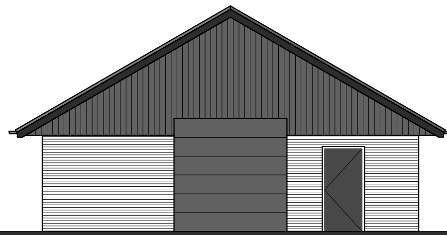
Voorgevel (Z-W) Gevel prefab elementen steenstrip Opgevel staand Douglas Overheaddeur aluminium antraciet
