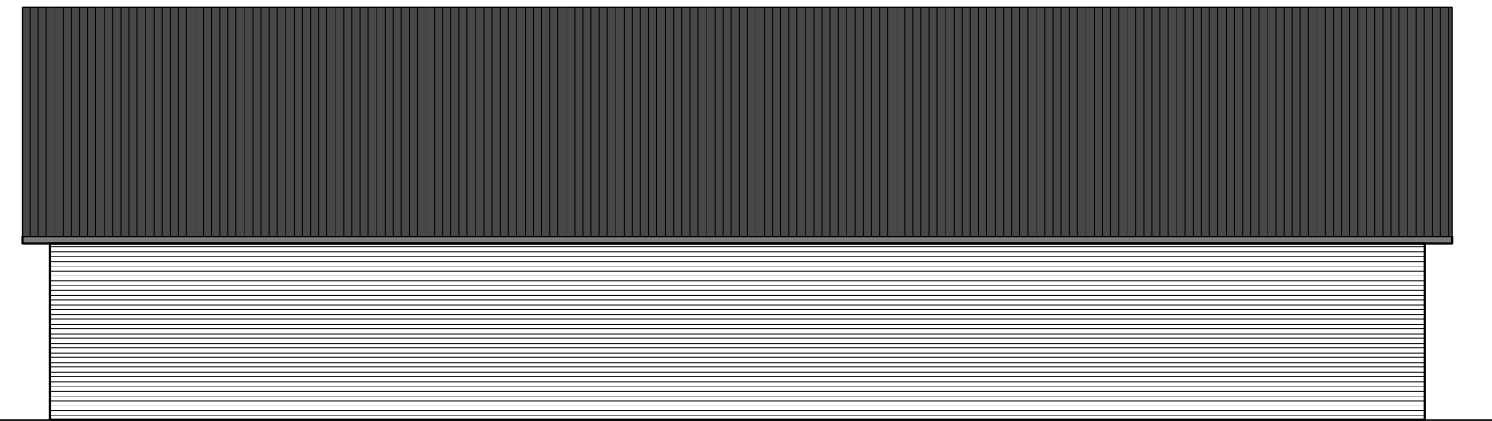
Linkergevel (N-W) Gevel prefab elementen steenstrip Dak stalen golfplaat sandwichpaneel
