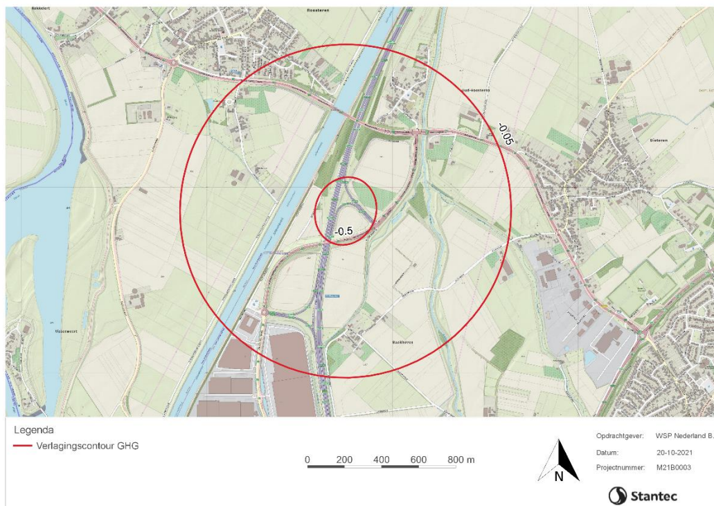
Figuur 5: Theoretisch invloedsgebied (verlagingscontour 0,05 meter en 0,5 meter) bij bemaling onder GHG (rode lijnen)
