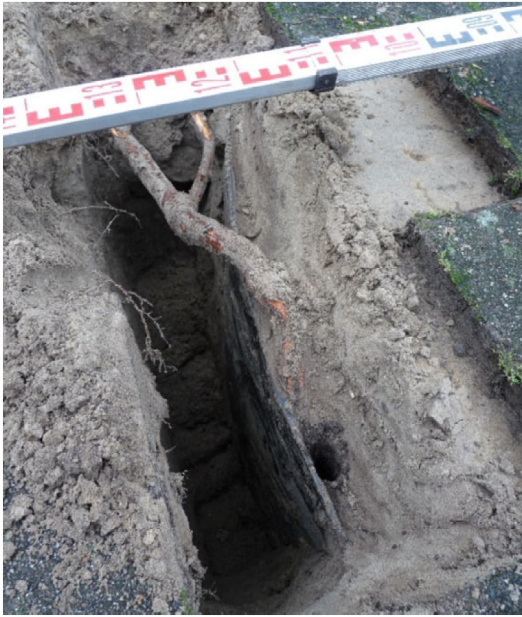
Afbeelding 9: 'Ontsnapte' wortel over het wortelscherm bij boom 1
