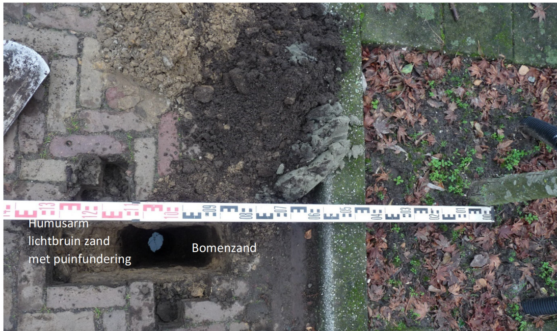
Afbeelding 12: Bomenzand tot op 115 centimeter vanuit de boom. Onderin is grondwater zichtbaar op 1 m-mv
