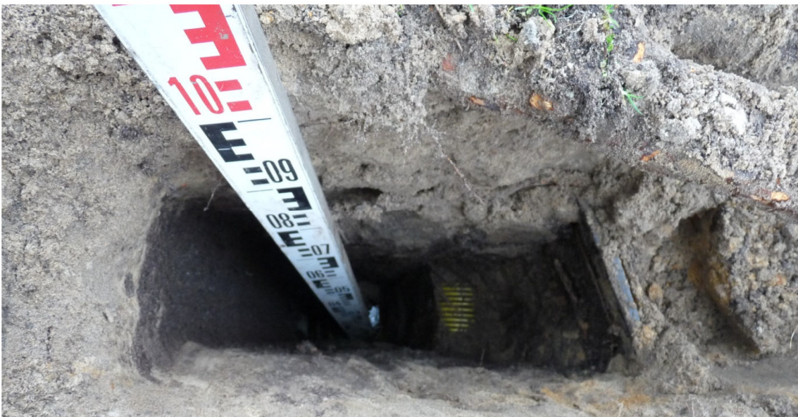
Afbeelding 11: Beluchtungsdrain zorgt voor uitwisseling van bodemgassen en zuurstof
