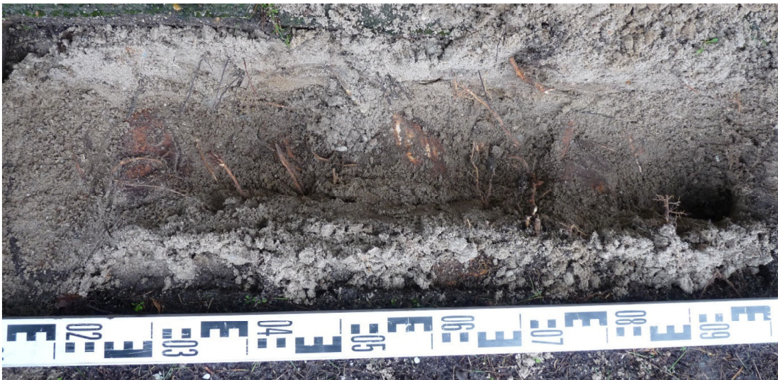
Afbeelding 14: Een aantal flinke stabiliteitswortels zijn er oppervlakkig aangetroffen
