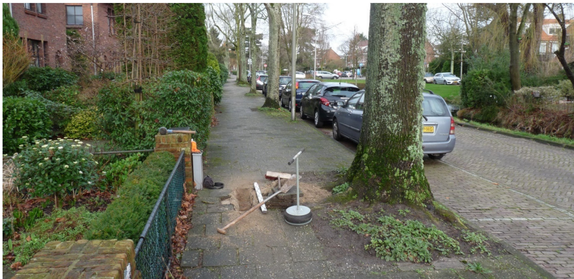
Afbeelding 19: Profielkuil tussen boom en particuliere tuin gegraven
