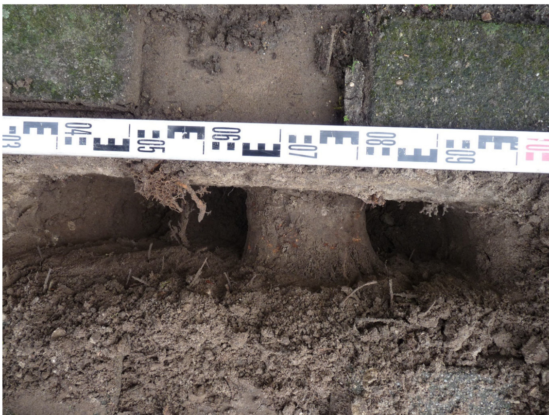
Afbeelding 22: Stabiliteitswortel met een diameter van 25 centimeter aangetroffen in de profielkuil. De wortel groeit naar de particuliere tuin toe
