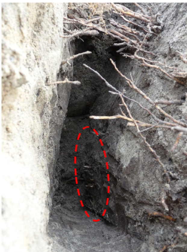
Afbeelding 17: Profielkuil aan de zijde waar geen wortelopdruk plaatsvindt gegraven, om zo tot een grotere diepte te komen
