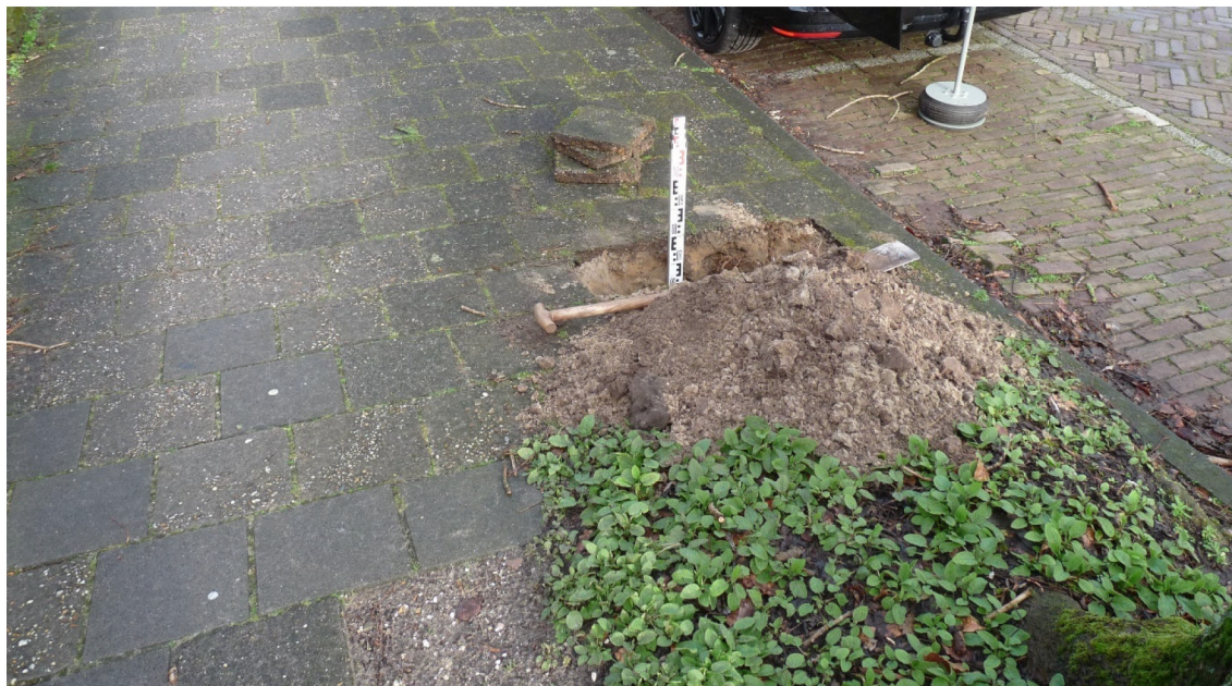
Afbeelding 17: Profielkuil aan de zijde waar geen wortelopdruk plaatsvindt gegraven, om zo tot een grotere diepte te komen
