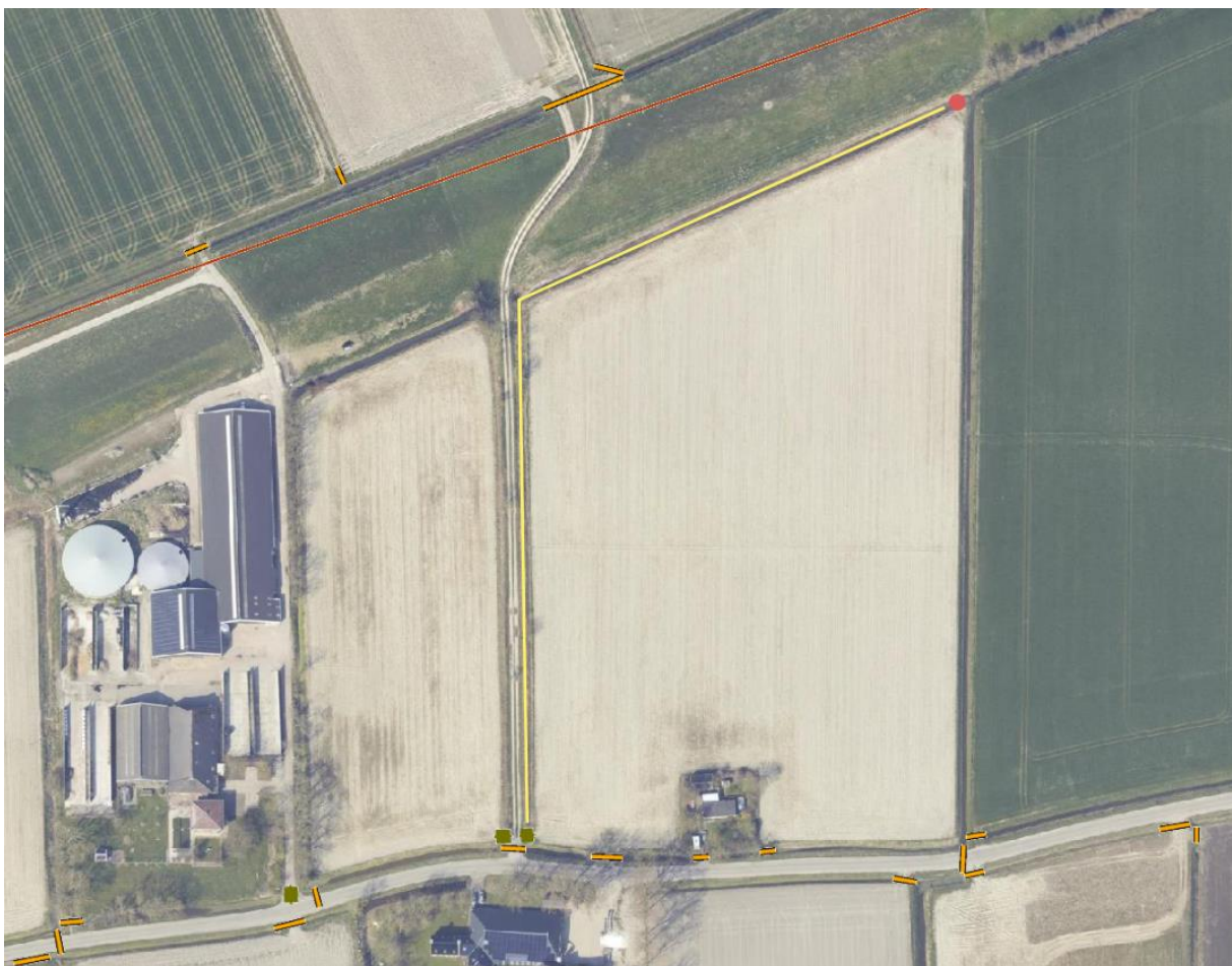
Figuur 1: geel = de watergang waarvan het waterpeil wordt verhoogd, rood = de aan te leggen dam
