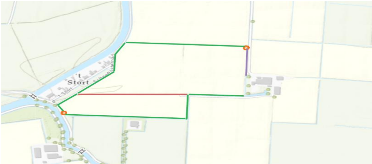
Figuur 1: De rode lijn geeft de te dempen watergang weer. De groene lijnen geven te verbreden watergangen weer. De paarse lijn geeft de nieuw te graven watergang weer. De oranje stippen geven de locatie van aan te leggen duikers weer.
