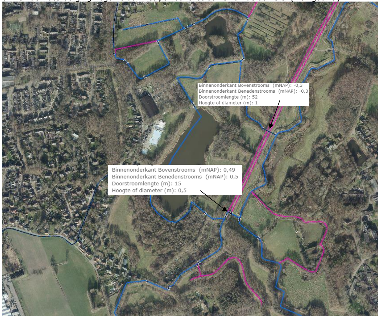
Figuur 9 Plaatsen terugslagkleppen benedenstrooms duikers
