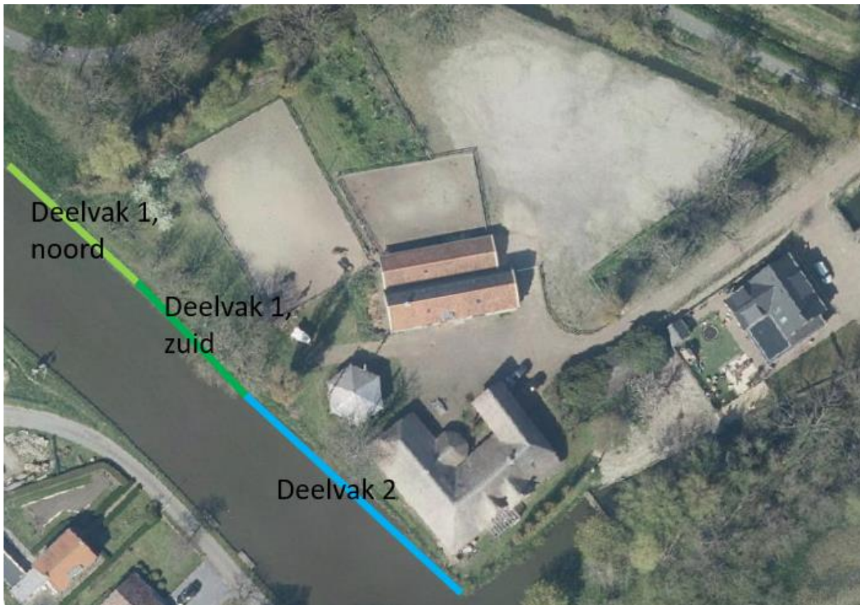
Figuur 2: Locatie van traject B113_1, de blauwe streep (2) geeft aan waar een deel van het boezemwater wordt gedempt, de groene streep (1) geeft aan de bestaande houten beschoeiing wordt vervangen, dit deel is in 2 type verdeeld, zie paragraaf 2.2.4.
