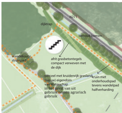
figuur 29. Aansluiting bestaand wandelpad op nieuwe dijk door middel van een dijktrap
