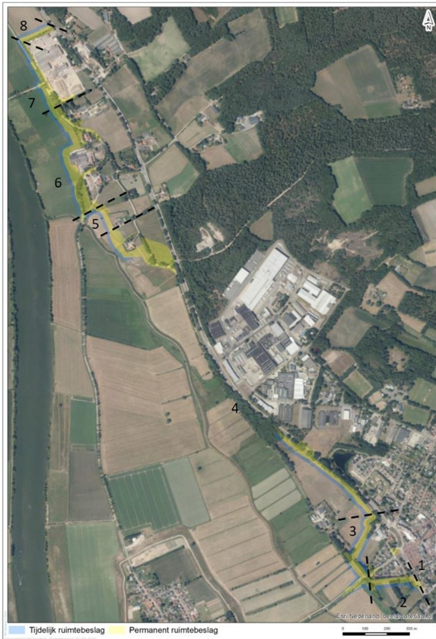
Figuur 6 Dijkvakken en deelgebieden inclusief ingepast VKA met tijdelijk (blauw) en permanent (geel) ruimtebeslag
