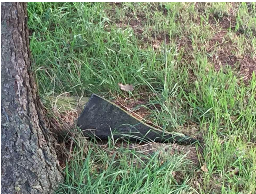
Afbeelding 12. Dit is mogelijk een stuk asbestplaat.
