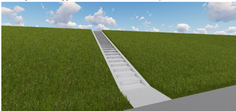
figuur 39. Principe beeld dijktrap, beton en opsluitrand, met kop- en voetplaat aansluitend op verharding maaiveld/ beheerpad. Deze bevindt zich in deelgebied 2, dijkvak 4.
