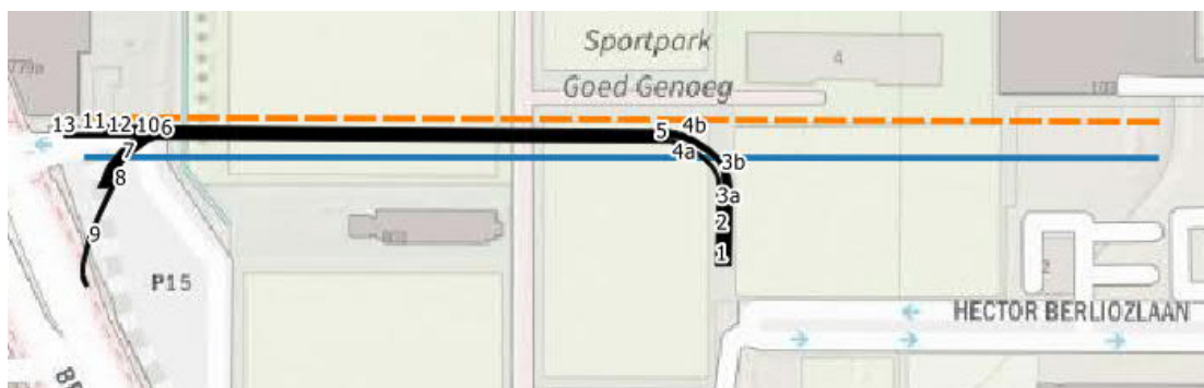
Figuur 1: Globale ligging kabels en leidingen bundeling (zwart), damwandconstructie (oranje) en tracé riolering en WKO leidingen (blauw)
