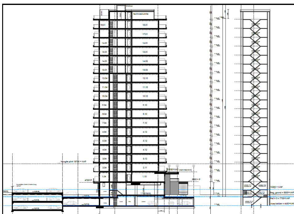
Figuur 6 Doorsnede hotel en garage
