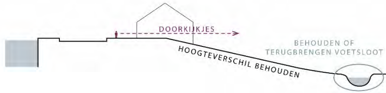
Behouden van hoogteverschillen, doorkijkjes en zichtbare voetsloot
