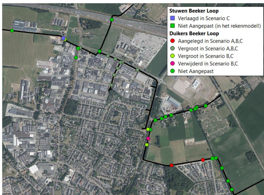
Figuur 6 – Aanpassingen aan duikers en stuwen per scenario. De bovenstroomse stuw wordt vanwege de bouw van Loverbosch II verplaatst, maar gezien de geringe afstand is dit niet meegenomen in het rekenmodel.
