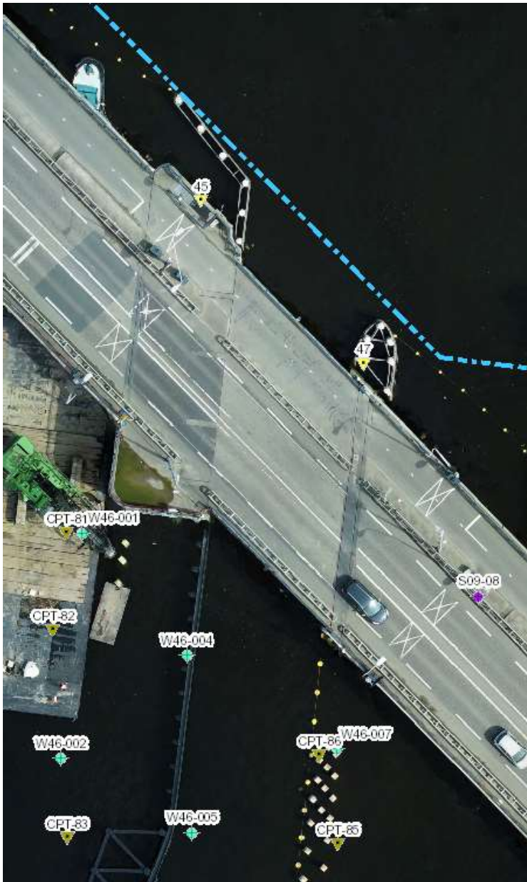
Figuur 7: Grondonderzoek ter plaatse van de bestaande Torenvlietbrug
