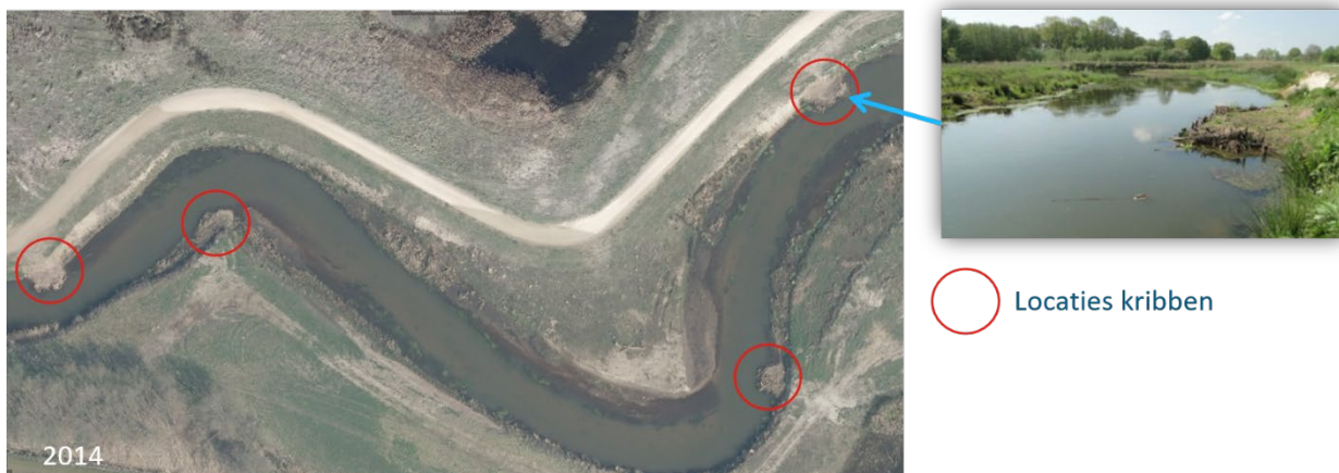
Figuur 14 Kribben aangelegd in 2014 bij Knooppunt de Hogt
