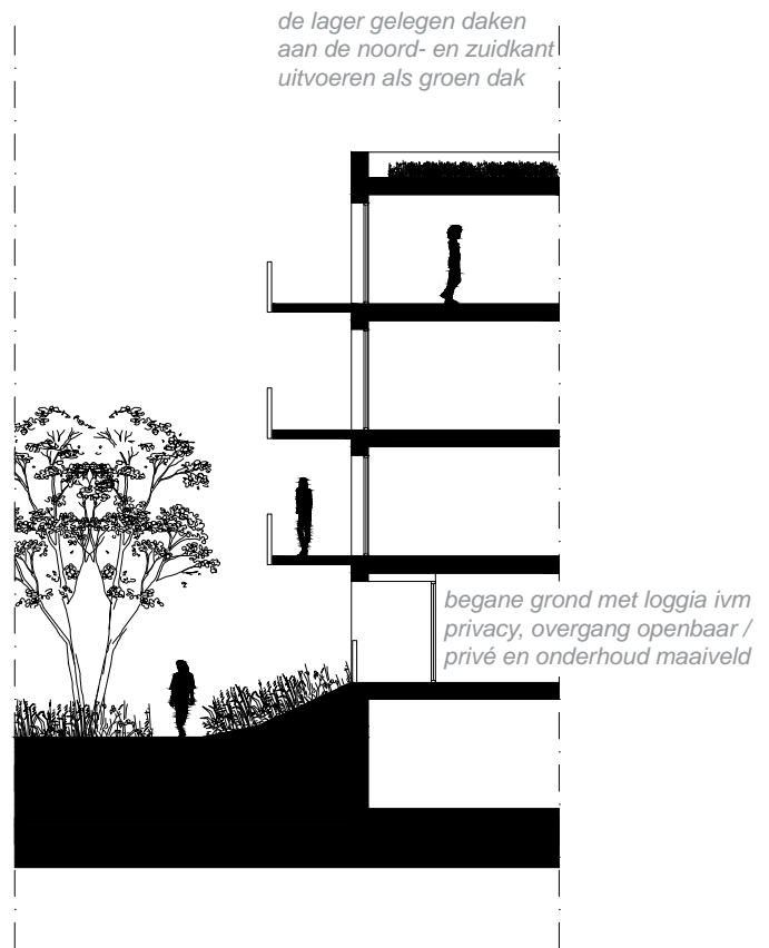
doorsnede ter plaatse van talud
