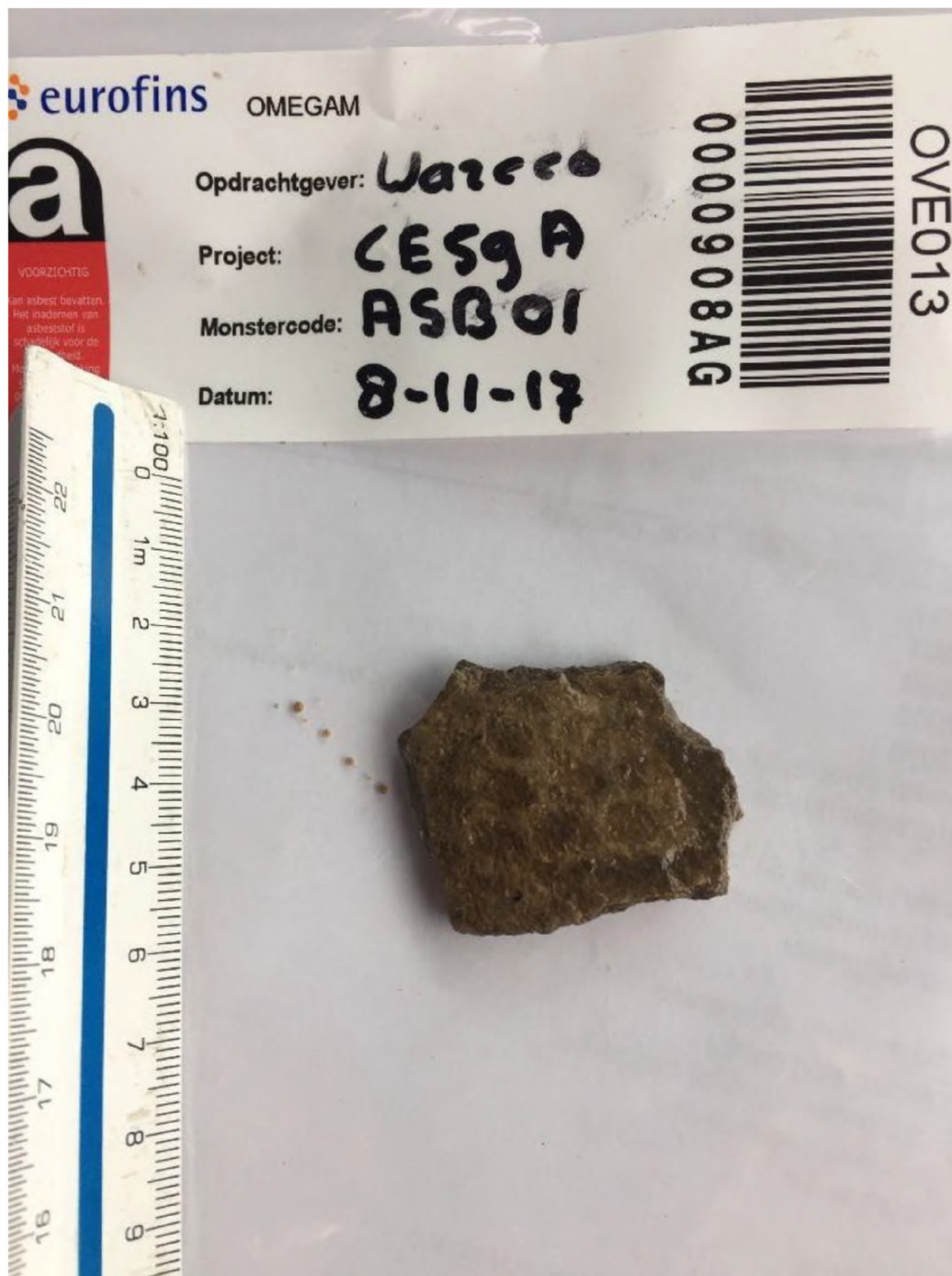
Foto 5: Asbestverdacht plaatmateriaal boorlocatie 16
