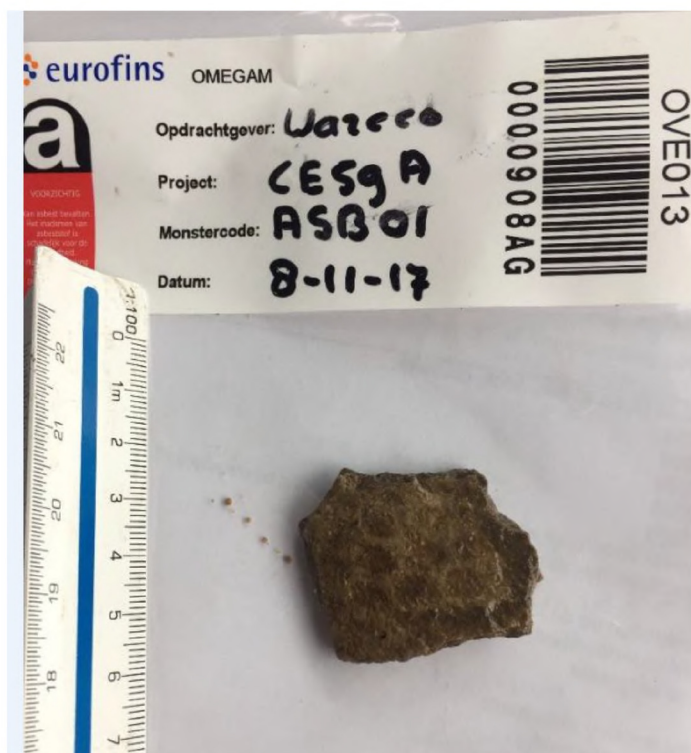
Figuur 3: Asbestverdacht plaatmateriaal boorlocatie 16
