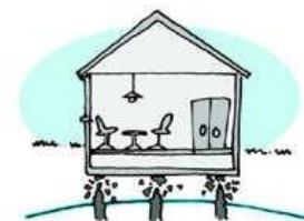
Grondwaterpeil te laag: paalrot
