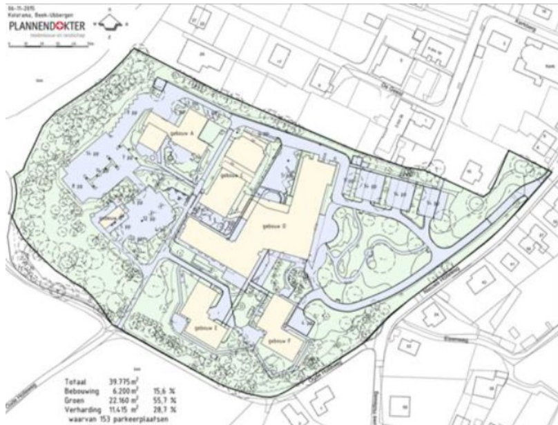
Figuur 1 Bestaande situatie met de gebouwen die gefaseerd gesloopt gaan worden. Bron: Plannendokter (uit Notitie vleermuisonderzoek Kalorama Beek 2016, Bureau Waardenburg)
