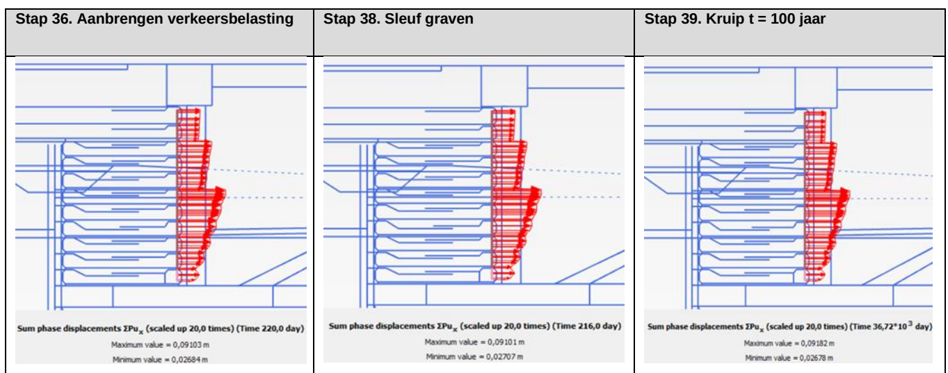
Figuur 18: Overzicht te verwachten horizontale verplaatsing - voorzijde
