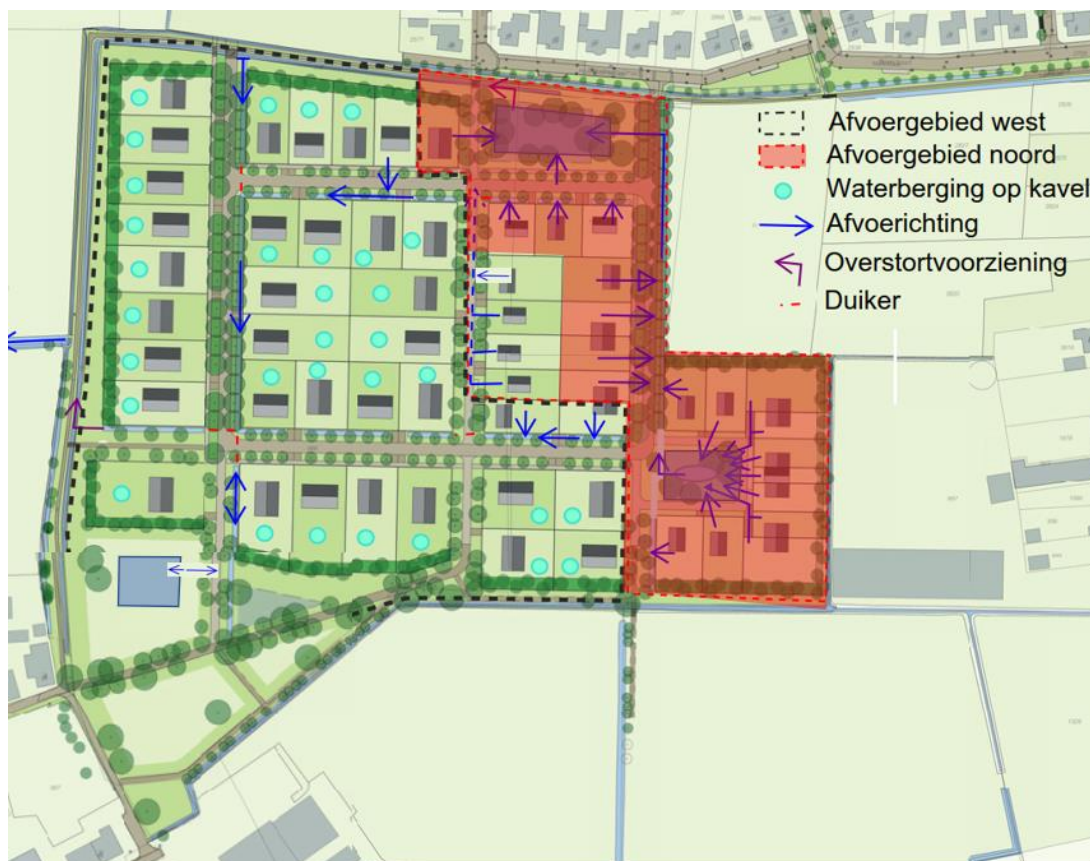
Figuur 4-1 Hemelwatersysteem Laarspad
