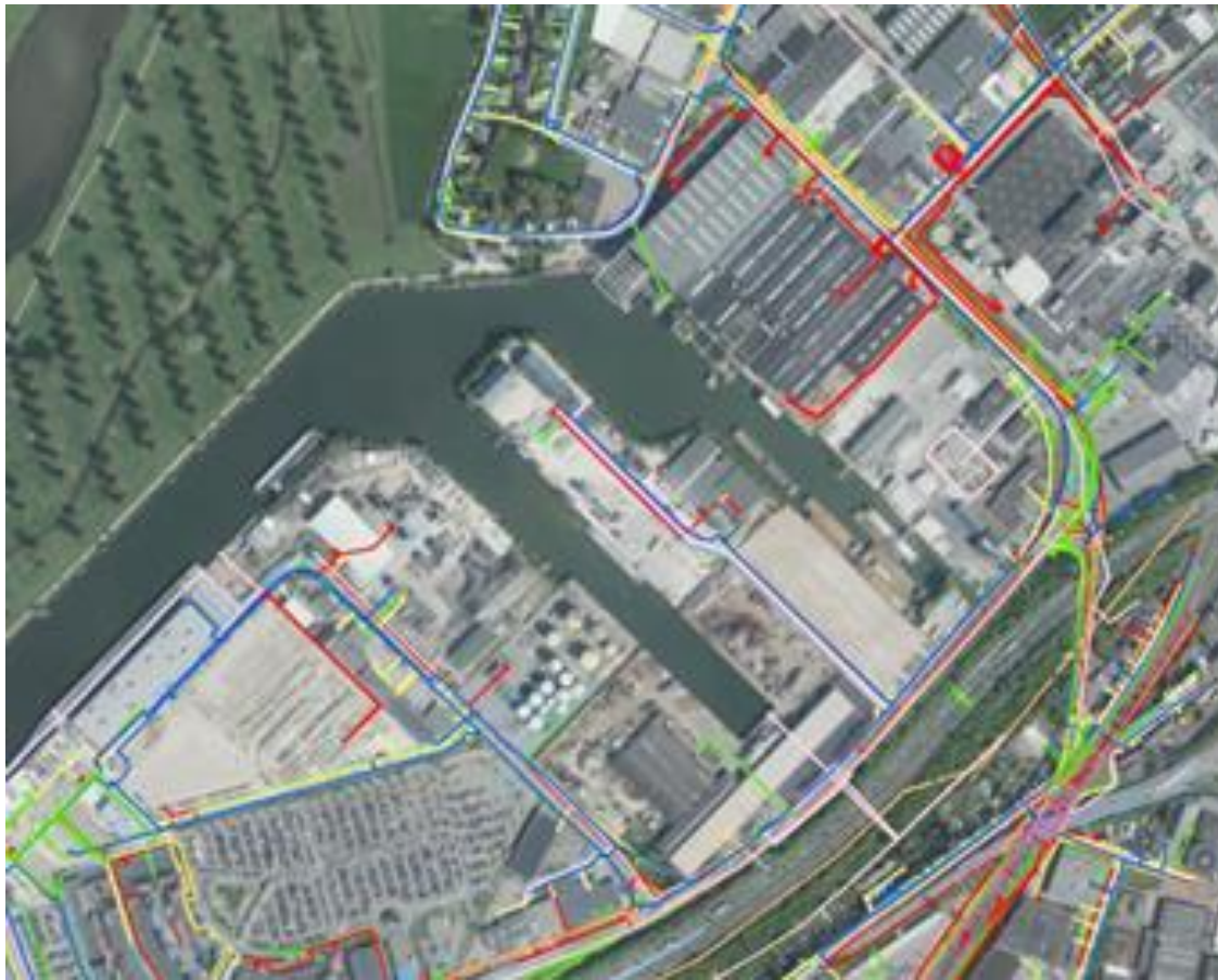
Figuur 3.2: Klic-melding Alexanderhaven (maart 2018). In kleuren zijn de diverse ondergrondse k&l aangegeven. Grijs/bl = Enexis LS, geel = Enexis gas, groen= data (KPN), oranje – Gas Enexis (HD), roze = riool vrijverval gemeente Roermond, rood = Enexis MS, blauw = water (WML)
