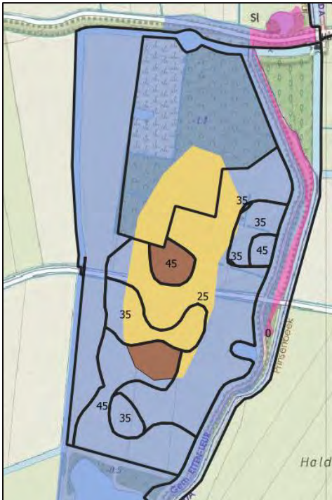
Figuur 3: In bruine kleur de gebieden die vanuit het VO meer dan 40cm afgegraven worden en overlappen met het archeologisch hoge verwachtingen gebied. Voor deze gebieden wordt het afgravingsniveau in het DO bijgesteld zodat verkennend booronderzoek niet nodig is.
