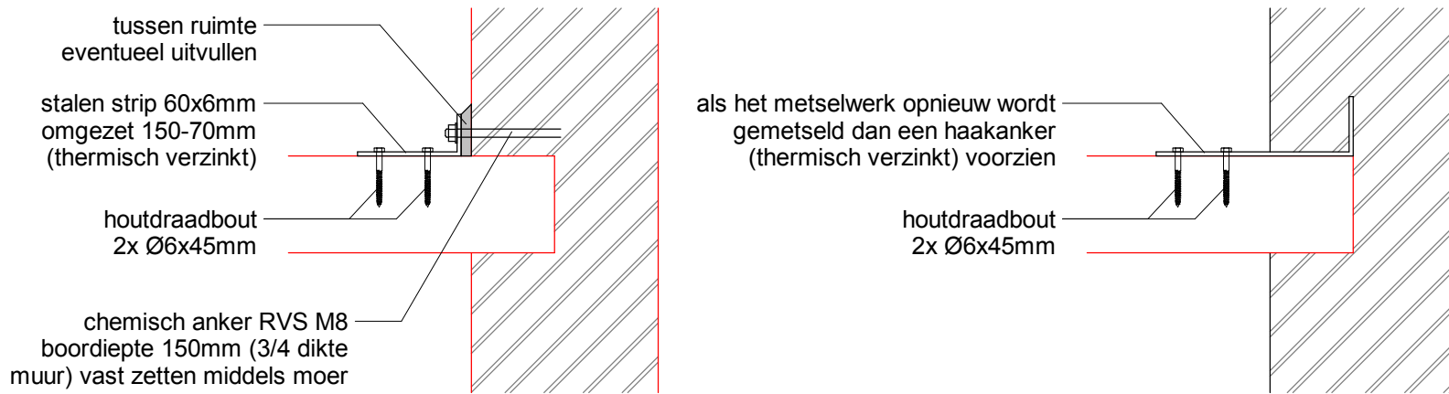
Principedetail 9 muurveranker
