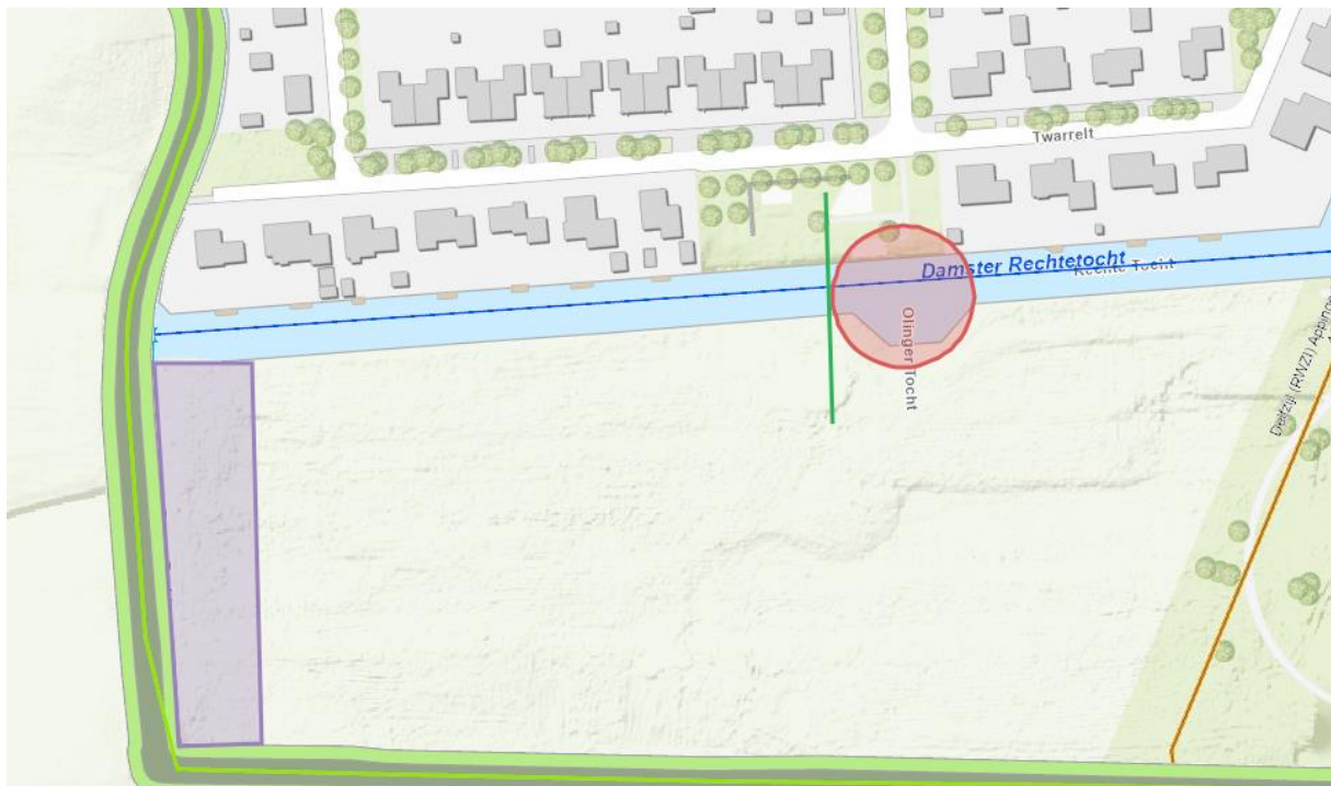
Figuur 1: De rode cirkel geeft het aanleggen van de tijdelijke brug weer, de groene lijn geeft de gestuurde boring weer en de paarse rechthoek toont de plek waar de secundaire watergang wordt verbreed.
