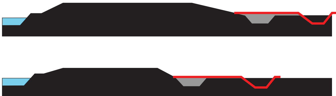
Figuur 43: principeprofielen dijkverbetering sectie A
